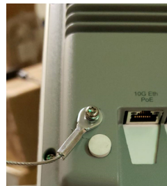
FIGURA 5 Fijación del cable de seguridad al punto de acceso
